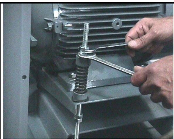
С помощью РЫЧАГА поднять опорную пластину двигателя и заменить ремни.
